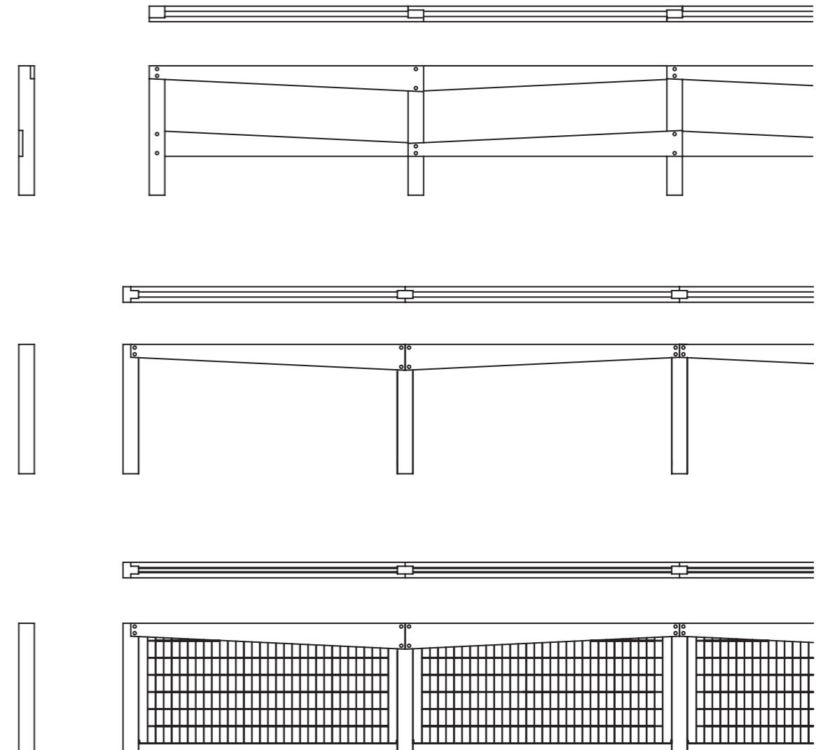
Pali a sezione quadrata e traverse in legno sono giuntati a "mezzo legno". I correnti sono ricavati per taglio da un unico asse commerciale e montabili secondo configurazioni diverse. Tre le versioni: delimitazione, staccionata, protezione totale (con pannello grigliato elettrozincato). Larice/frassino impregnato con nano tubi anti UV. Collegamenti a terra in acciaio zinkato a caldo.
