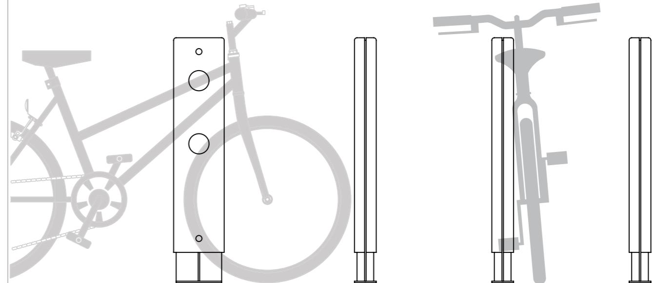
Portabiciclette conformato per l'appoggio del mezzo, con fori a diversa altezza per l'assicurazione del mezzo (telaio e ruota).
